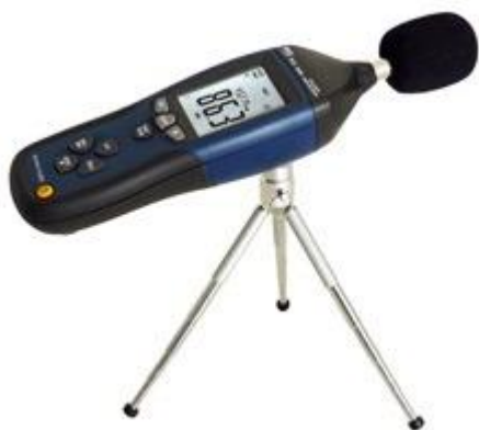
Sonomètre effectuant une mesure avec le trépied
