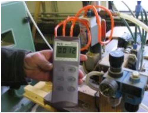
Manomètre PCE-P mesurant la pression différentielle d'une machine industrielle
