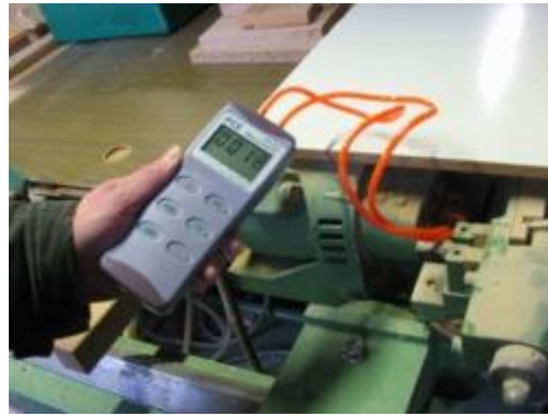
Mesure de la pression de l'air dans une machine avec ce manomètre
