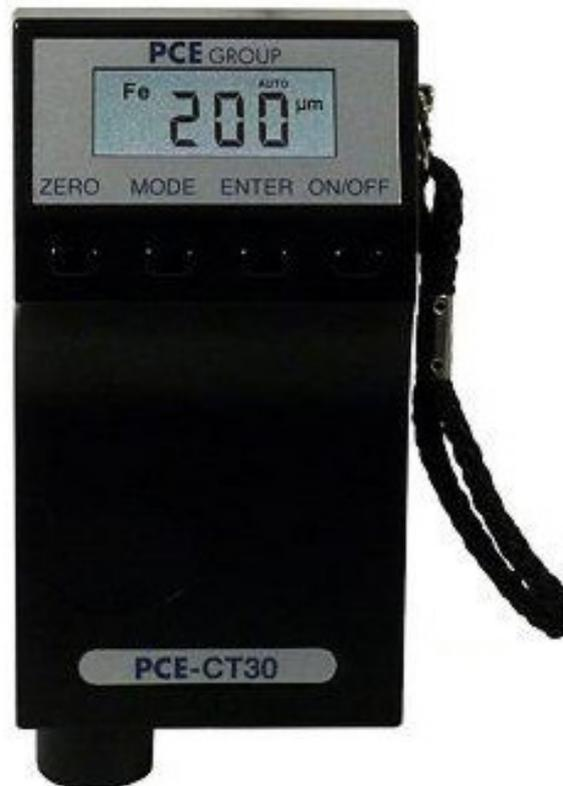
Félicitations pour l'achat de notre mesureur d'épaisseur PCE-CT30. Le mesureur appartient à une gamme de mesureurs d'épaisseur de recouvrement non destructifs. Il est facile et pratique à utiliser et permet à l'utilisateur d'effectuer tous les réglages nécessaires avec la notice. Le mesureur peut s'utiliser pour une grande variété d'applications. L'électronique moderne et la carcasse robuste garantissent une longue durée de vie des instruments à haute précision.
