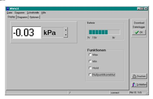
Vous pourrez choisir d'autres unités avec les flèches. Les fonctions MIN, MAX, HOLD et de remise à zéro s'activent et se désactivent avec la souris. La tension actuelle de la batterie mise sur l'appareil est indiquée avec un diagramme de barres vert.
