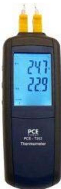
Les thermomètres de contact (à deux entrées) donne une réponse rapide et une précision de laboratoire. Ces thermomètres fonctionnent avec deux thermo éléments de type k ou de type j comme capteurs de température et donnent une résolution de 0.1°C / 0.1°F.
