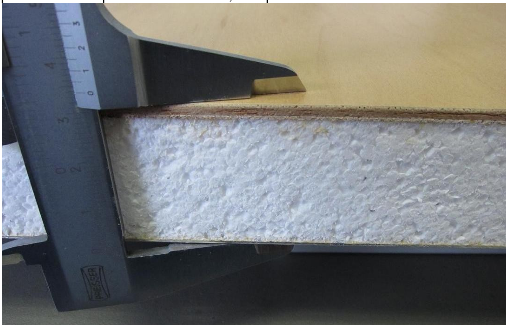
Exemple sandwich: aluminium- isolement - contreplaqué
