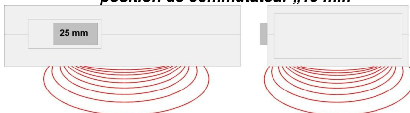
Vue latérale: Champs de mesure et profondeur de pénétration en position de commutateur „25 mm“
