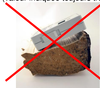
Mal: Surface irrégulière
