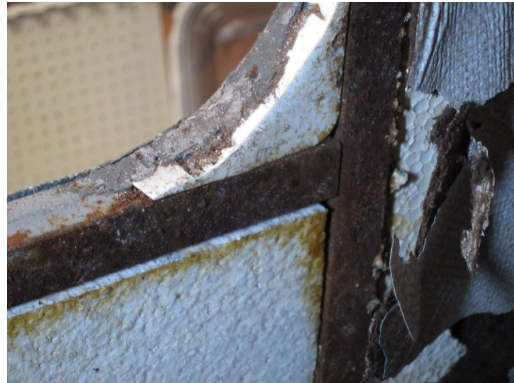
Isolement et encadrement métallique dans les (auto)caravanes les plus antiennes
