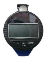
Pour remplacer la batterie, insérez la pointe du tournevis petit ou objet similaire et retirez attentivement le couvercle du compartiment de la batterie et le support de la batterie. Placez la batterie nouvelle et ensuite placez à nouveau le support et le couvercle du compartiment. Faites attention à la polarité.
