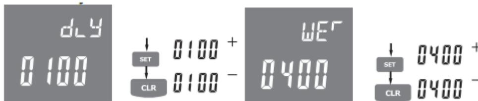
L'indicateur séchage/humidité peut se programmer aux valeurs déjà prédéfinies spécialement par le mode indice. Cela produit un nouvel réglage pour la valeur de seuil "Humide" et "Sec".
