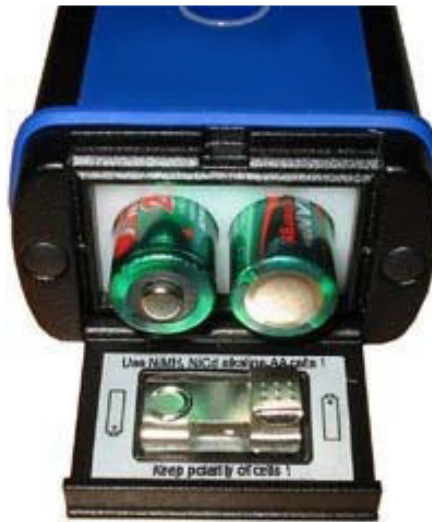
Emplacement des batteries
