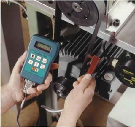
La distance entre la courroie de transmission et la sonde de mesure devrait être entre 3 et 20 mm. Veuillez voir l'image pour une position correcte.
