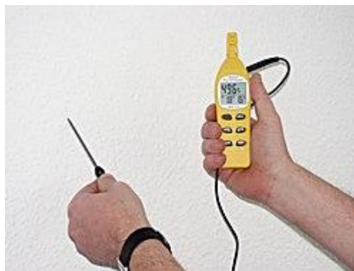
Hygromètre mesurant l'humidité d'un mur
