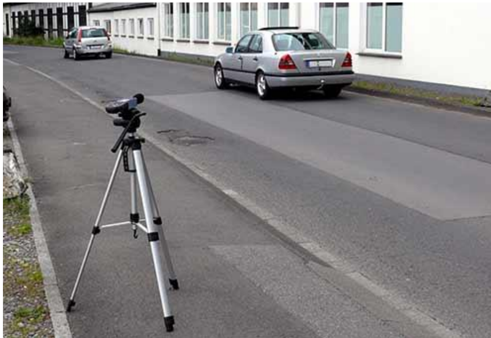
Effectuant une mesure du niveau de bruit du trafic
