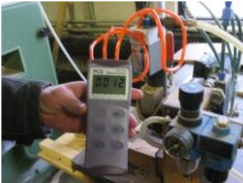
Manomètre PCE-P mesurant la pression différentielle d'une machine industrielle
