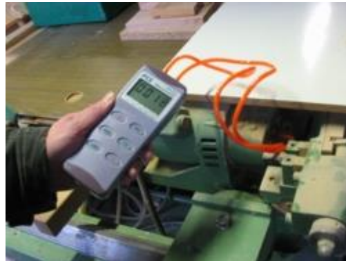
Mesure de la pression de l'air dans une machine avec ce manomètre
