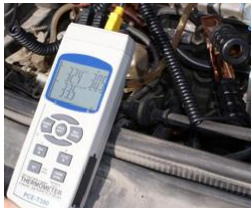
Mesure de la température du moteur d'une voiture avec le thermomètre et une sonde à tige
