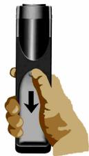
Pour remplacer la batterie, vous devez appuyer sur le couvercle de la partie inférieure de l'appareil vers le bas. S'il vous plaît, assurez-vous d'insérer la batterie dans la direction correcte.
