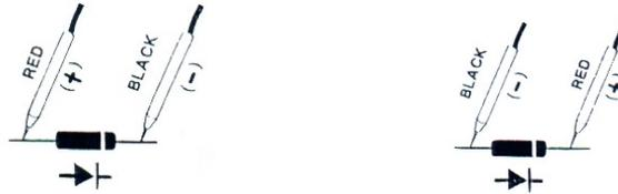
Si vous avez disposé les câbles de contrôle de la façon décrite en la deuxième illustration, la mesure de la diode vers derrière aura lieu. Si la diode est bien, "OL" apparaîtra sur l'écran. Si la diode est défectueuse, "000" apparaîtra sur l'écran. Quand on effectue la mesure des diodes on devrait utiliser les deux méthodes.
