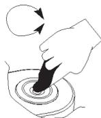
2. Utilisez une pipette en plastique, placez l'échantillon sur la surface du prisme. Remplissez la cellule complètement.
