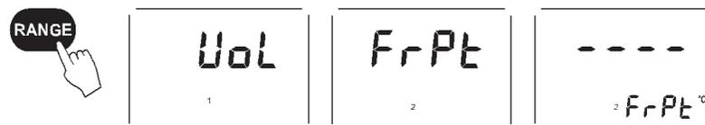
Note: La mesure de température n'apparaît pas sur l'écran dans le mode Point de Congélation.
