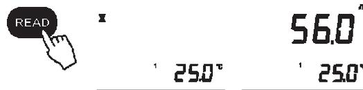
**Note:** La valeur de la dernière mesure apparaîtra jusqu'à que le suivant échantillon soit mesuré ou l'appareil soit éteint. La température s'actualisera tout le temps.
